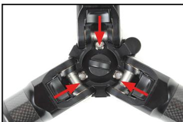
In der Stativschulter sind 3 Madenschrauben eingebaut. Diese werden von unten mit dem beigegeführten Inbusschlüssel bedient. Nach dem Aufsetzen eines Kugelkopfs oder Nivellierhilfe (z.B. LB-15) werden die Madenschrauben angezogen. Damit ist der Kugelkopf etc. auf der Schulter gesichert. Zum Abschrauben des Kugelkopfes erst die Madenschrauben lösen.
