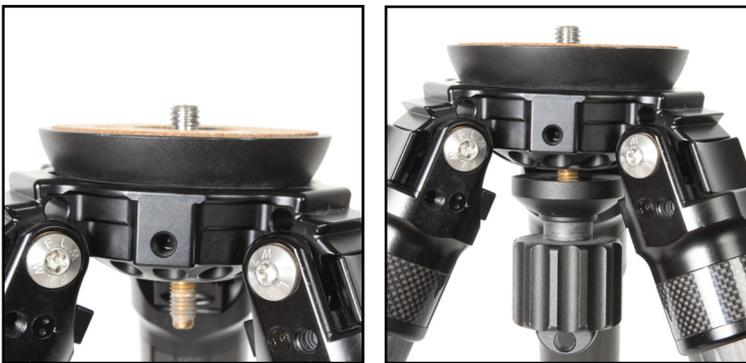
Für die Montage des HB-75 wird zunächst die Schulterplatte demontiert. Dies geschieht durch Öffnen der Flügelschraube unter der Stativschulter. Nach dem vollständigen Entfernen der Flügelschraube lässt sich die Schulterplatte abnehmen. Der HB-75 wird in montiertem Zustand geliefert. Daher dort zunächst die geriffelte Stellschraube vollständig öffnen und abnehmen.
