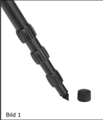
Das Wechseln zwischen gehärteter Stahlspitze und GummifuÙ geht bei den FLM-Stativen der Serie CP-30 und CP-34 sehr einfach, schnell und problemlos von statten. Durch das Ab-, bzw. Aufdrehen der Gummikappe wird der Spike freigelegt, bzw. wieder verdeckt. Die Gummikappe wird durch Drehen nach links abgedreht und der Spike kommt zum Vorschein (Bild 1).
